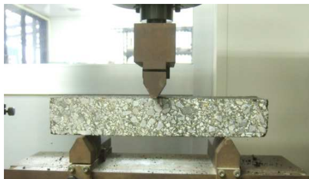
写真 混合物の曲げ試験状況
