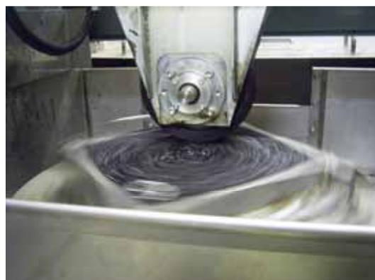
写真: 混合物のねじれ試験状況
