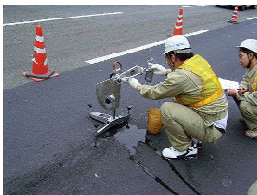
写真. 地方道の坂道での施工例(密粒ギャップ) (すべり抵抗性試験 (BPN) 状況)
