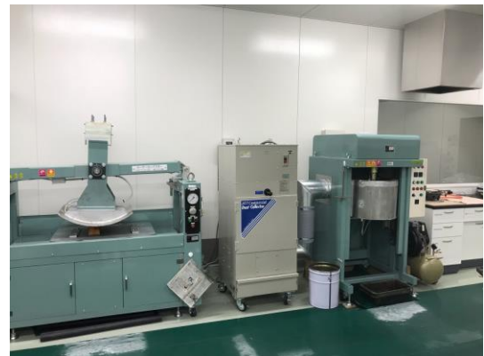
【集塵機付き合材ミキサー】
