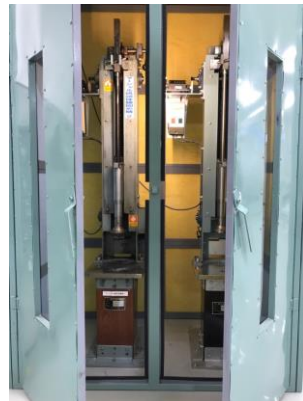
【マーシャル突き固め機】
