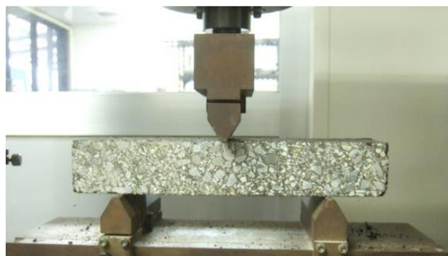
写真 混合物の曲げ試験状況
