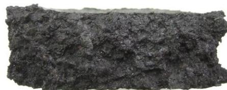
写真 エコーフィックスを用いた混合物の水浸ホイールトラッキング試験後供試体 (剥離率0%)
