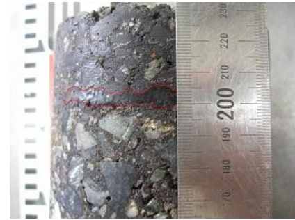
写真-1 乳剤の混合物下部への充填
