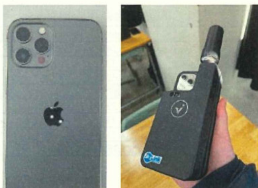
図-1 iPhone 12 Pro max の LiDAR センサーと viDoc を取り付けた iPhone
